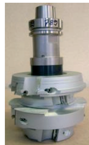
Bild 5.27: Werkzeugsplitting für ein stationäres CNC-Bearbeitungszentrum: Auf einer Aufnahme befinden sich zwei zusammengehörige Profile (Quelle: Holzfachschule Bad Wildungen)
