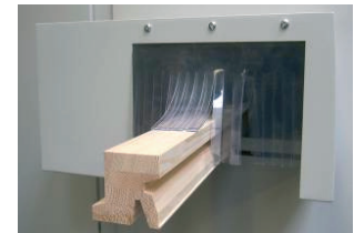
Bild 1.60: Vorprofilierung auf programm- gesteuerten Profilfräsautomaten (Quelle: Holzfachschule Bad Wildungen)
